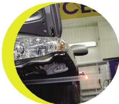
Лазерная диагностика геометрии кузова измерительной системой EMS 2 A TROMMELBERG
