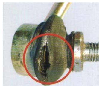
ПОВРЕЖДЕНИЕ УПЛОТНИТЕЛЬНОГО СИЛЬФОНА НА СТАБИЛИЗАТОРЕ В СЛЕДСТВИЕ УДАРА КАМНЕМ ИЛИ КАСАНИЯ АВТОМОБИЛЕМ ЗИМОЙ.
