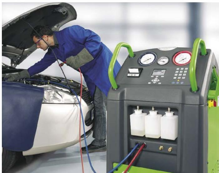
**НЕКАЧЕСТВЕННЫЙ ФРЕОН СОСТОИТ ИЗ НЕСКОЛЬКИХ ГАЗОВ, СРЕДИ КОТОРЫХ МОГУТ БЫТЬ R22, R40, R600 И ДРУГИЕ НЕИЗВЕСТНЫЕ ВЕЩЕСТВА, ДАЖЕ ПРИ НЕБОЛЬШОЙ УТЕЧКЕ ИЗМЕНИТСЯ ДАВЛЕНИЕ В КОНДЕНСАТОРЕ И ИСПАРИТЕЛЕ КОНДИЦИОНЕРА, НАРУШАТСЯ ТЕРМОДИНАМИЧЕСКИЕ СВОЙСТВА.**
