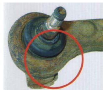
ПРИМЕР ТИПИЧНОГО ОБРАЗОВАНИЯ РЖАВЧИНЫ НА ДЕТАЛИ ХОДОВОЙ ЧАСТИ, ВЫЗВАННОГО ВОДЯНЫМИ БРЫЗГАМИ ИЛИ СОЛЬЮ ДЛЯ ПОСЫПКИ УЛИЦ.
