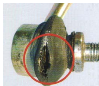
ПОВРЕЖДЕНИЕ УПЛОТНИТЕЛЬНОГО СИЛЬФОНА НА СТАБИЛИЗАТОРЕ ВСЛЕДСТВИЕ УДАРА КАМНЕМ.
