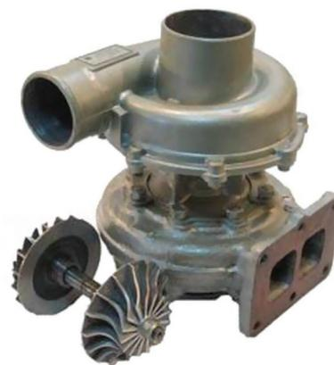
Турбина двигателя M57
