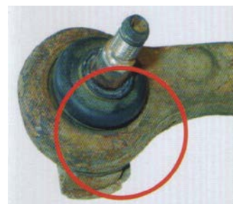
ПРИМЕР ТИПИЧНОГО ОБРАЗОВАНИЯ РЖАВЧИНЫ НА ДЕТАЛИ ХОДОВОЙ ЧАСТИ, ВЫЗВАННОГО ВОДЯНЫМИ БРЫЗГАМИ ИЛИ СОЛИ ДЛЯ ПОСЫПКИ УЛИЦ.
