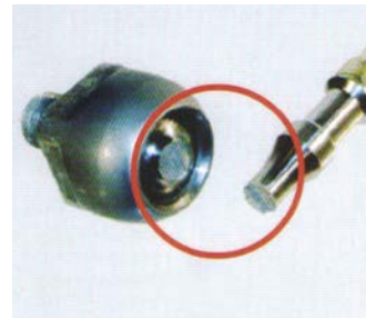
ОТРЫВ ОСЕВОГО ШАРНИРА В СЛЕДСТВИЕ ПЕРЕТЯГИВАНИЯ ПРИ НАЕЗДЕ НА БОРДЮРНЫЙ КАМЕНЬ ИЛИ ПРИ ПЕРЕЕЗДЕ ЧЕРЕЗ ВЫБОИНУ.
